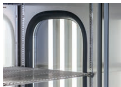
Много света, но не слишком много тепла: эти люминесцентные трубки термически отделены от камеры.
