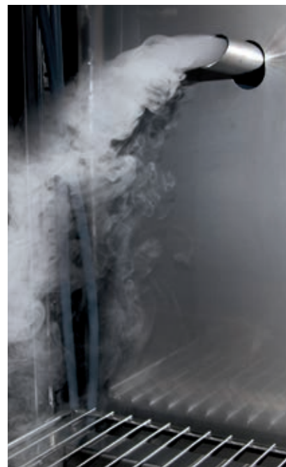
Создание аэрозольного тумана без притока тепла в камеру
